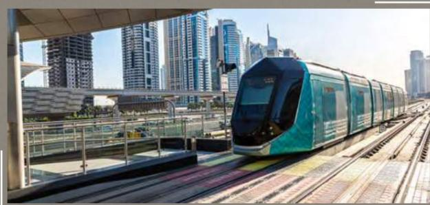
هذا ويعد ترام دبي أول مشروع ترام خارج أوروبا يعمل بنظام التغذية الكهربائية الأرضية على كامل الخط، من دون الحاجة إلى أسلاك الكهرباء العلوية، كما يعد النظام الأول في العالم الذي يستخدم تقنية البوابات الآلية لمنصة محطة الركاب والمتوافقة مع نظام فتح وغلق البوابات في القطار، وذلك لتوفير أكبر قدر من عوامل الراحة والسلامة والأمان للركاب، والحفاظ على نظام التكييف للبيئة الداخلية للمحطات والعربات من التأثيرات المناخية الخارجية.
